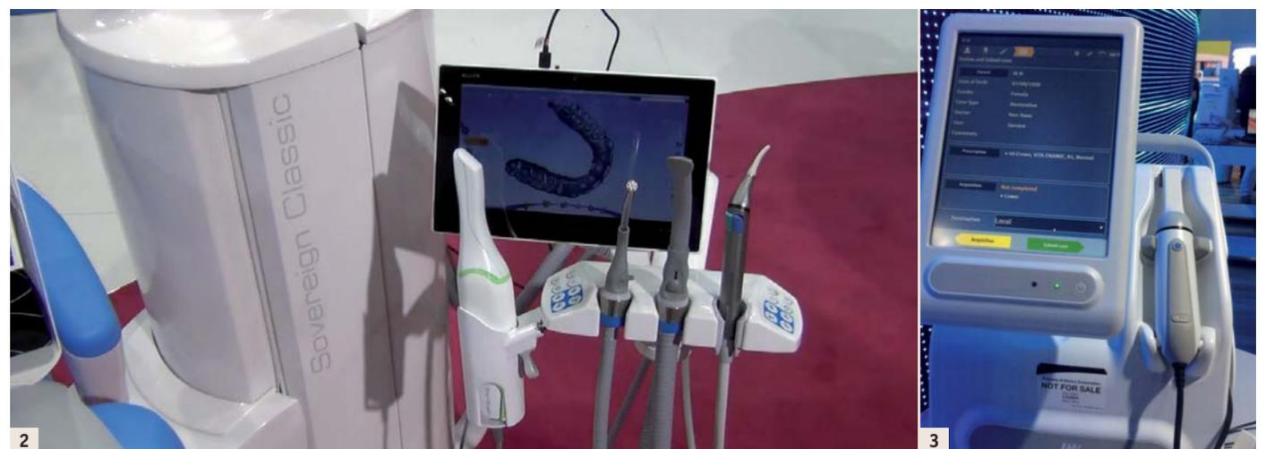
Fig. 2 : Ergonomie avec le PlanScan de Planmeca : le scanner intra-oral et la tablette numérique sont fixés sur l'unité. | Fig. 3 : Scanner intra-oral KaVo. Acquisition numérique sans poudrage et en monochrome.
