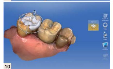
Puis vérifiez l'épaisseur de la restauration, lorsqu'une zone est trop fine, le logiciel la fait apparaître sous forme d'une bulle bleu-ciel.
